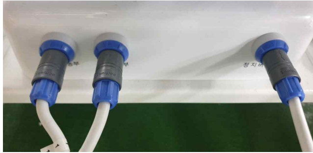
그림 14 구동부 및 비상정지버튼 소켓
